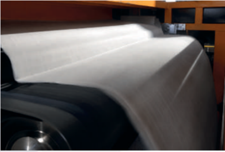
Roll Manyetik Seperatörde ki Malzeme Akışı (Material Flow in Roll Magnetic Separator)
