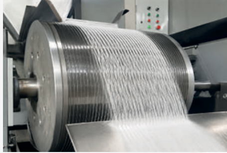
Roll Manyetik Seperatörde ki Malzeme Akışı (Material Flow in Roll Magnetic Separator)
